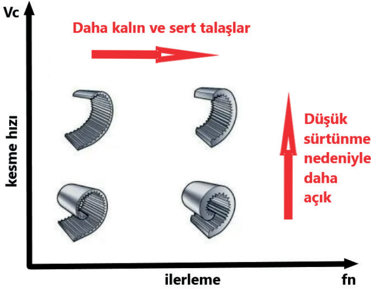
Şekil 1.25: Talaş oluşumunun delme parametrelerine göre değişimi ( https://www.sandvik.coromant.com/tr-tr/knowledge/drilling , 2022)
