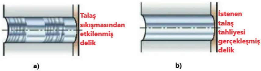
Şekil 1.21: Talaş tahliyesine bağlı delik yüzeyi: a) İstenmeyen b) İstenen ( https://www.sandvik.coromant.com/tr-tr/knowledge/drilling , 2022)
