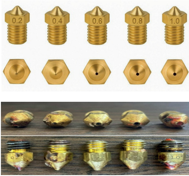
Şekil 1. Deneylerde Kullanılan Nozuller a) Kullanılan nozullerin şematik gösterimi b) Baskı işleminden sonra nozullerin görünümü
