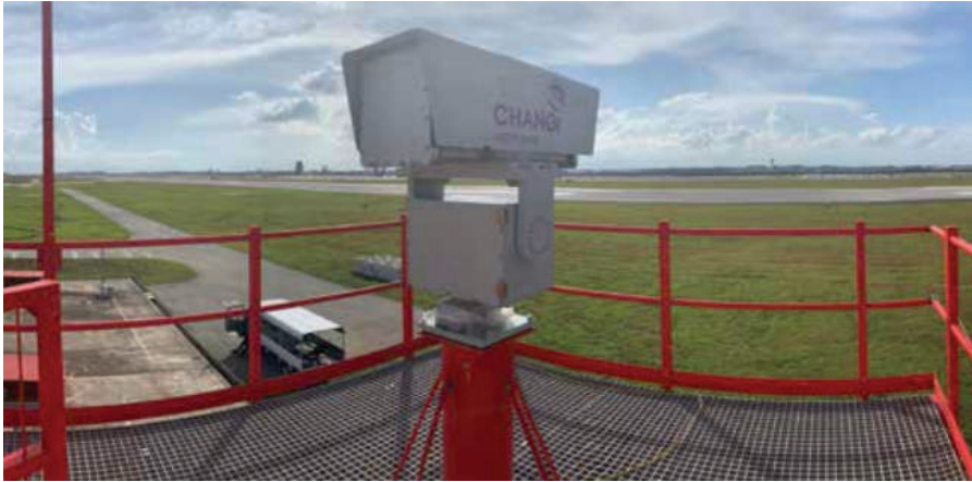
Görsel 2: Yabancı Cisim (FOD) Tespitinde Kullanılan iFerret Uygulaması
