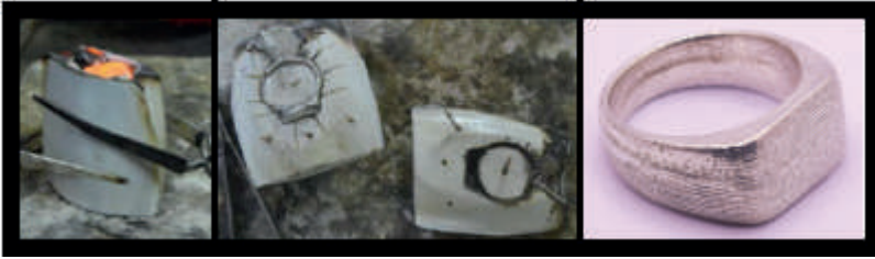
Şekil 4D. Döküm İşleminin Tamamlanması
