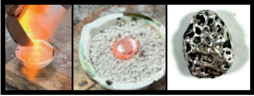
Şekil 13. Kedi kumuna döküm tekniği ve çıkan ürün.
