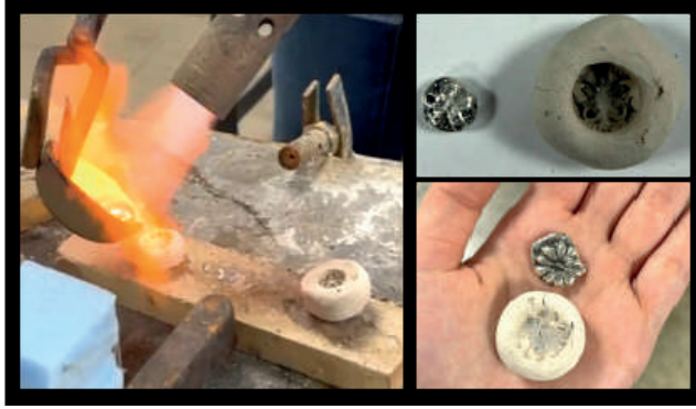
Şekil 14. Çamur Döküm İşlemi ve Sonucu.
