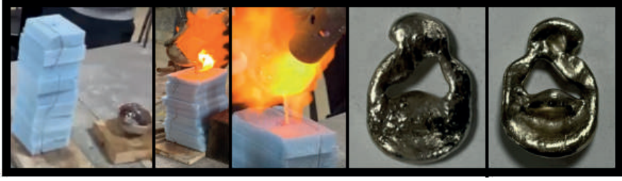
Şekil 16. Kartonpiyer alçıya döküm işlemi ve sonucu.
