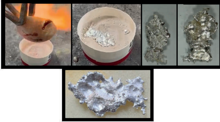
Şekil 15. Kartonpiyer alçıya döküm işlemi ve sonucu.
