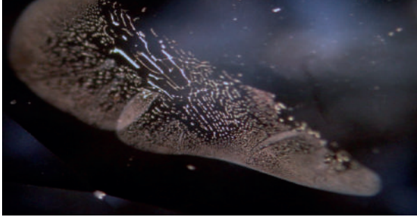
Şekil 18. İşlenmemiş Burma mavi safirinde sıvı parmak izi kalıntısı https://gemologyproject.com/wiki/index.php?title=File:Liquid_fingerprint_inclusion_in_untreated_Burmese_blue_sapphire_2.jpg
