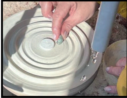
Şekil 5: Krizoprasın son cila aşaması keçe ve krom oksit ile sağlanmaktadır.
