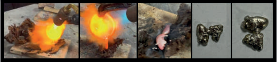
Şekil 21. Ağaç dallarına döküm tekniği aşamaları ve çıkan ürün.
