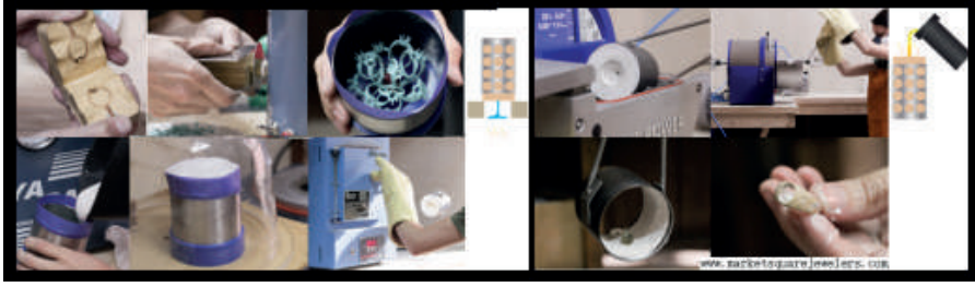
Şekil.2 Kayıp mum tekniği aşamaları ( https://www.marketsquarejewelers.com 'dan alınmıştır)
