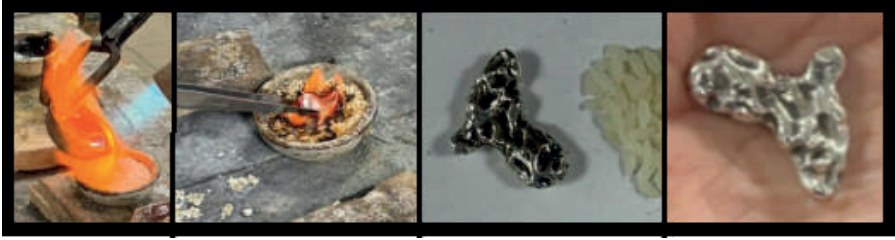
Şekil 7. Pirinç taneleri üzerine döküm ve çıkan ürün.
