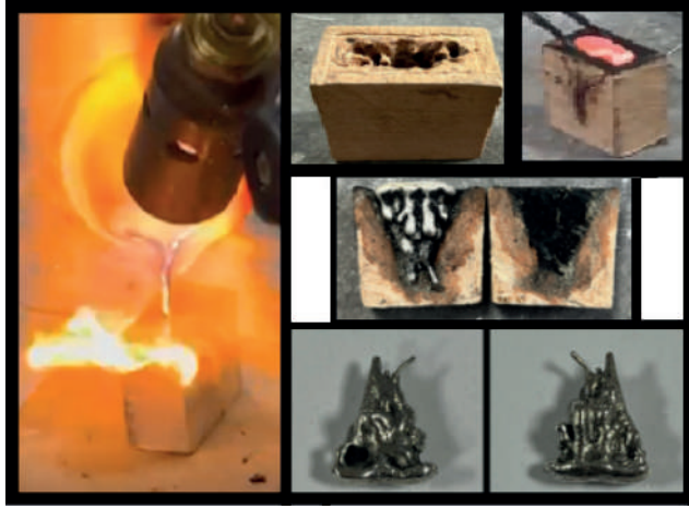
Şekil 22. Ahşap kalıba döküm tekniği aşamaları ve çıkan ürün.
