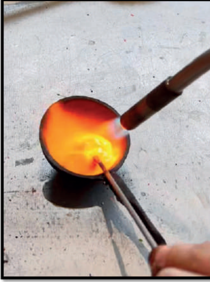
Şekil 4. Camın ergitilme işlemi
