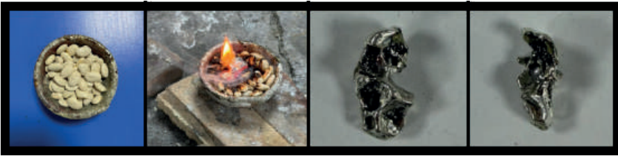
Şekil 6. Fasulye ile döküm ve çıkan ürün.
