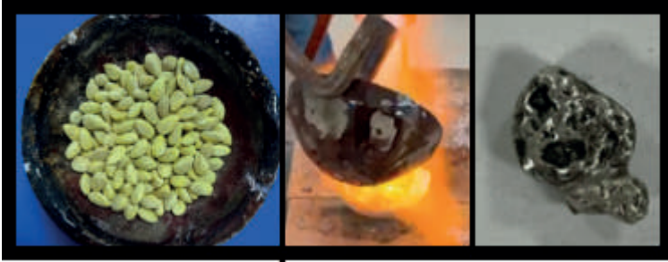
Şekil 8. Limon çekirdeğine döküm ve çıkan ürün.
