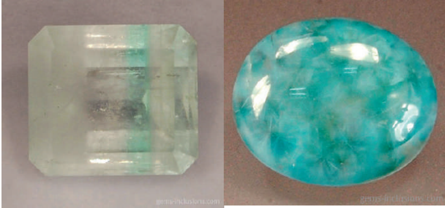
Şekil 48. Solda renksiz, şeffaf beril, keskin yeşil zümrüt bölgesi ve sıvı kapanımlarından kaynaklanan iki yarı saydam sütlü bölge içermektedir https://www.gems-inclusions.com/inclusions-in-gemology/color-distribution/ sağda paraiba kuvarısı” olarak adlandırılan bu kuvars, gilalit inklüzyonları nedeniyle renklenmiştir https://www.gems-inclusions.com/shop/category/by-included-mineral/gilalite/
