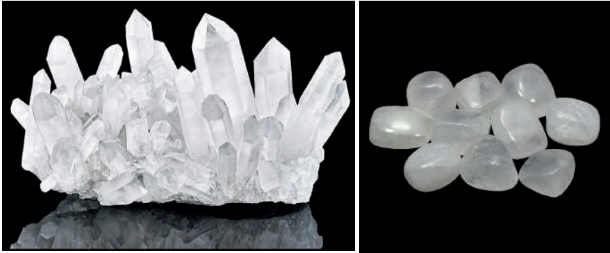
Şekil 42. Sütü kuvars opak ve bulanık görünümüyle bilinen yaygın bir kuvars çeşididir . Ayırt edici sütü beyaz tonu, oluşum sırasında kristal içinde hapsedilmiş mikroskobik su veya gaz inklüzyonlarından kaynaklanır. Bu inklüzyonlar ışığı dağıtarak kuvarsın karakteristik bulanık görünümünü oluşturur. Renk, bu inklüzyonların konsantrasyonuna bağlı olarak soluk beyazdan koyu sütü beyaza kadar değişebilir. https://www.geologyin.com/2014/06/milky-quartz.html
