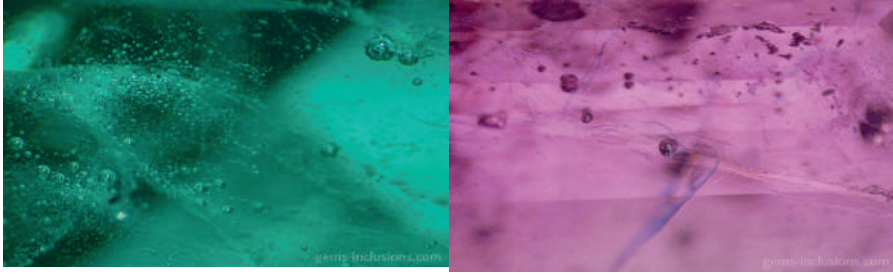
Şekil 3. Gaz kapanımlar Zümrüt taklidi yapay camda gaz balonları grupları. Kurşun cam dolgulu yakutta gaz balonları ve parlama etkisi ( https://www.gems-inclusions.com/inclusions-types/by-phase-filling/single-phase/vapor )
