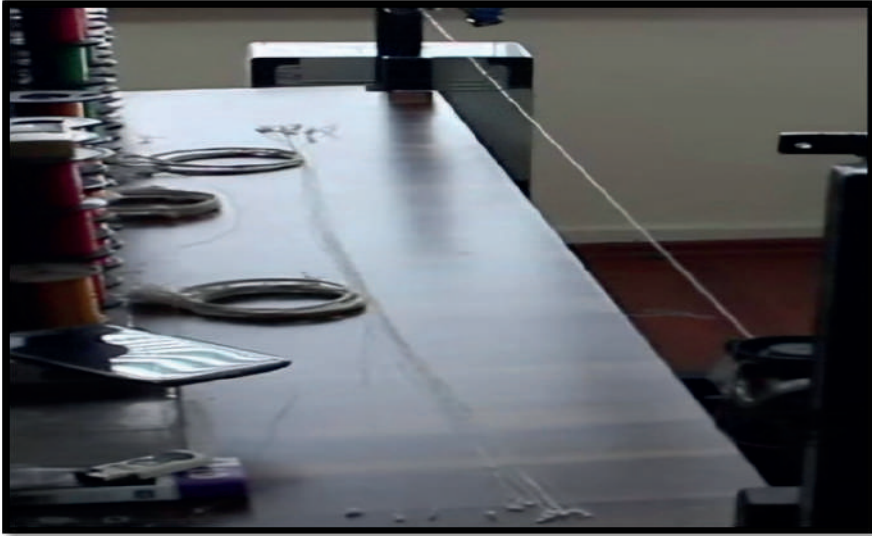
Şekil 3. Kazaz zanaatında (kaynaksız örgü tekniği) kullanılmak üzere tel çekimi için hazırlanmış özel düzeneğe çıkırık sistemi.
