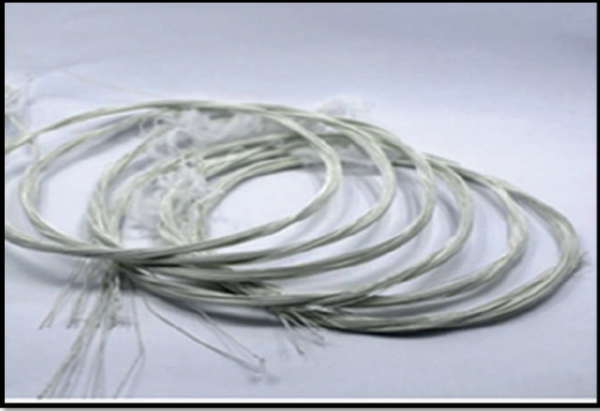
Şekil 4. Kazaz zanaatında (kaynaksız örgü tekniği) kullanılmak üzere hazırlanmış, saç kılı (0,08-0,18 mikron) kalınlığındaki 995 milyem altın veya 995 ayar gümüş teller.
