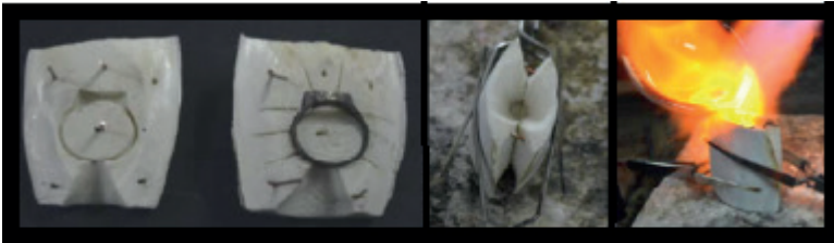
Şekil 4C. Sübye kemiğine döküm işlemi.
