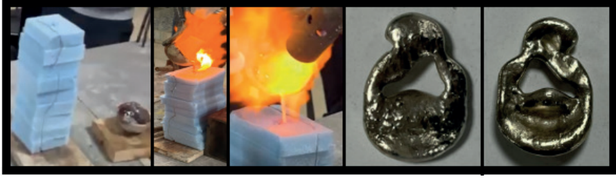
Şekil 16. Kartonpiyer alçıya döküm işlemi ve sonucu.
