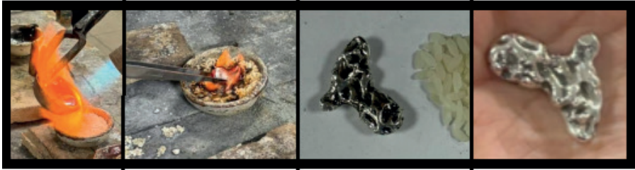
Şekil 7. Pirinç taneleri üzerine döküm ve çıkan ürün.
