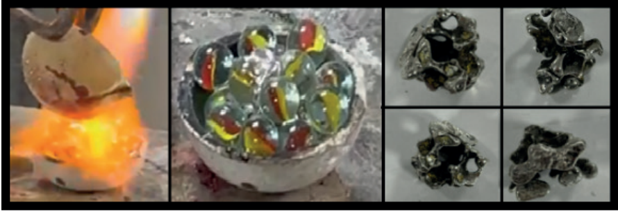
Şekil 20. Cam bilyelere döküm tekniği aşamaları ve çıkan ürün.
