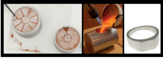
Şekil 3D. Kuma döküm aşaması.
