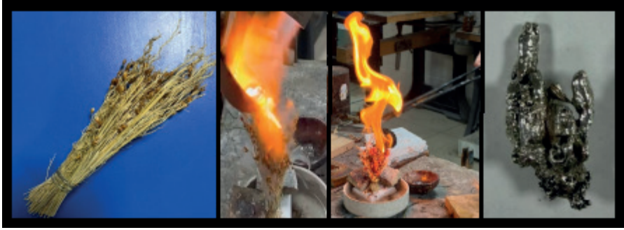
Şekil 10. Süpürgeye döküm ve çıkan ürün.
