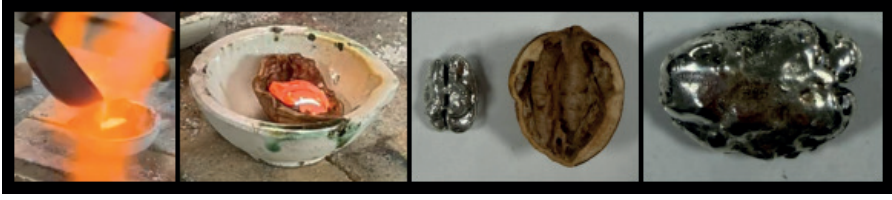
Şekil 11. Ceviz Kabuğuna Döküm ve çıkan ürün.
