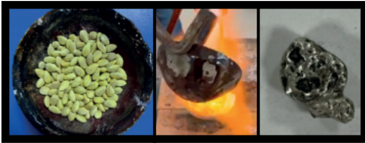
Şekil 8. Limon çekirdeğine döküm ve çıkan ürün.
