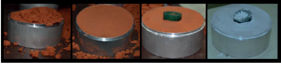
Şekil 3B. Kuma döküm aşaması.
