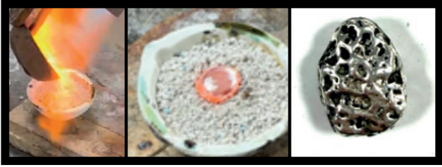
Şekil 13. Kedi kumuna döküm tekniği ve çıkan ürün.
