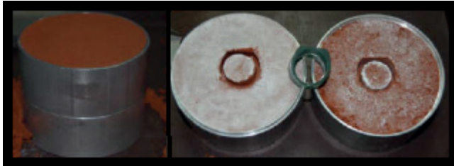
Şekil 3C. Kuma döküm aşaması.
