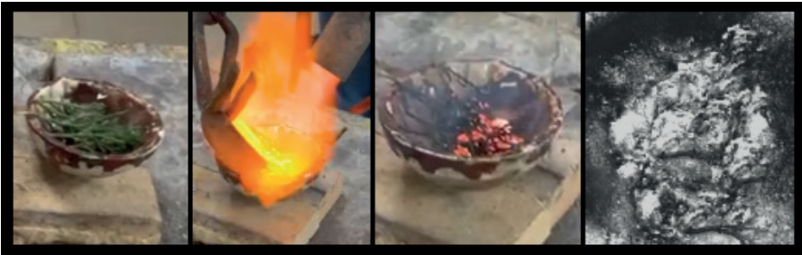
Şekil 9B. Farklı şekildeki çam yaprağına döküm ve çıkan ürün.
