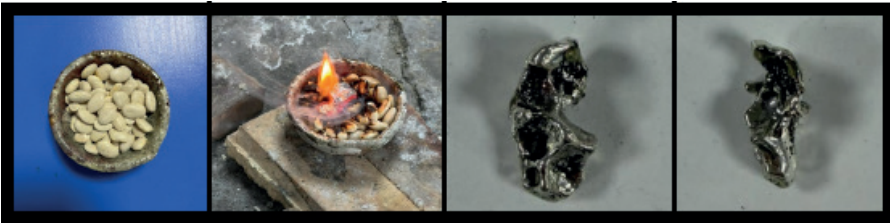
Şekil 6. Fasulye ile döküm ve çıkan ürün.
