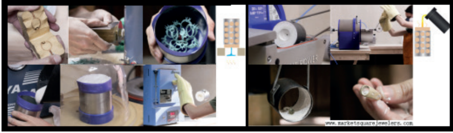
Şekil.2 Kayıp mum tekniği aşamaları ( https://www.marketsquarejewelers.com 'dan alınmıştır)
