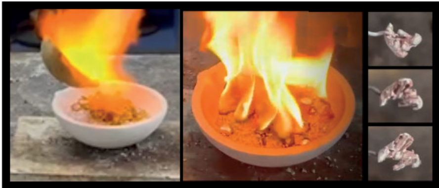
Şekil 19. Ceviz kabuğuna döküm tekniği, aşamaları ve çıkan ürün.
