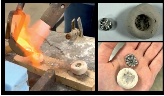
Şekil 14. Çamur Döküm İşlemi ve Sonucu.
