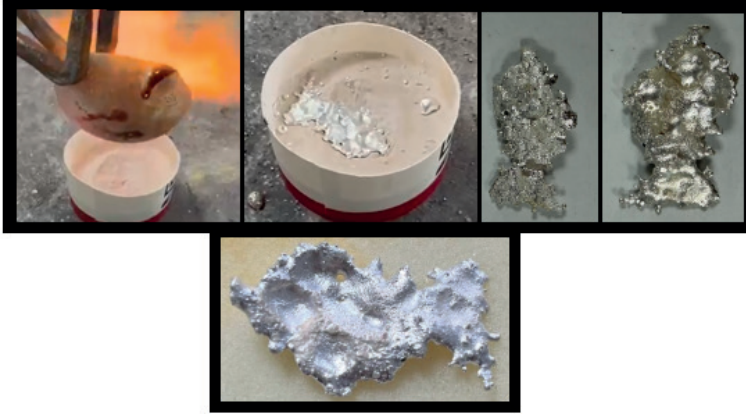
Şekil 15. Kartonpiyer alçıya döküm işlemi ve sonucu.
