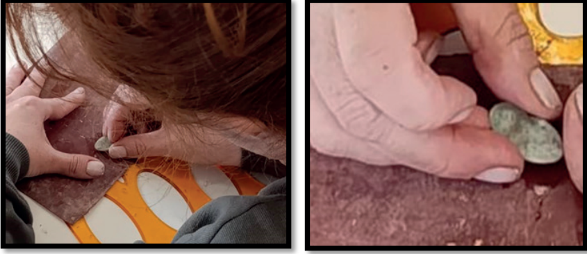
Şekil 4: Krizoprasın yüzey porozitesinin alınması için yapılan silisyum carbür taş aşındırma işlemi.
