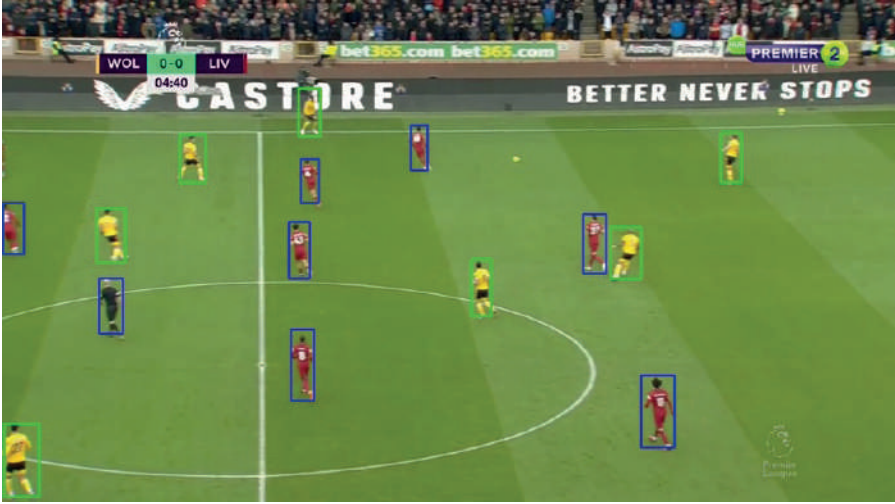
Şekil 4. Futbolda takım formasyonu ve davranış analizi için bilgisayarlı görü temelli oyuncu tespiti ve takibine örnek.
