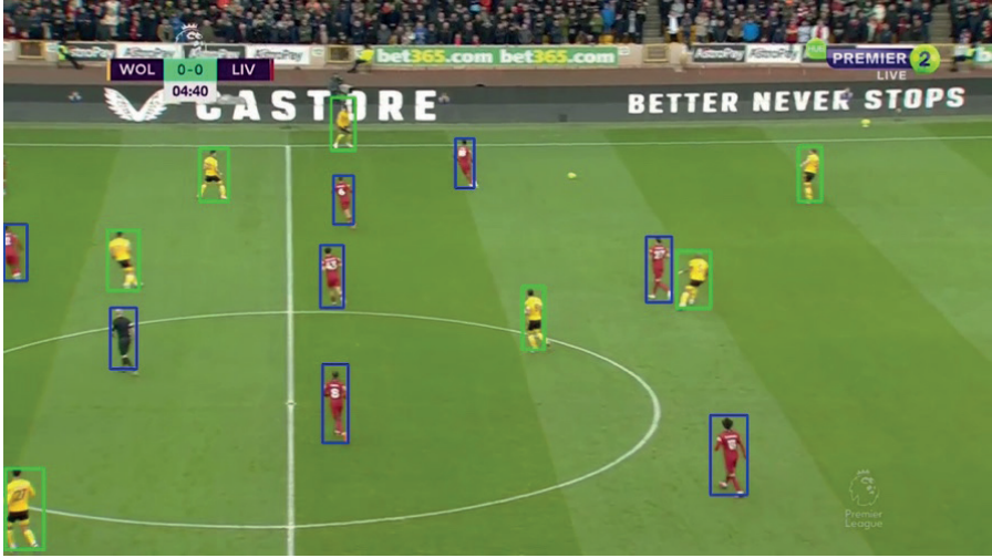
Şekil 4. Futbolda takım formasyonu ve davranış analizi için bilgisayarlı görü temelli oyuncu tespiti ve takibine örnek.
