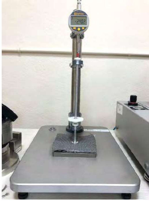
Şekil 5.3 2kPa standart ağırlıkta kalınlık ölçümü
