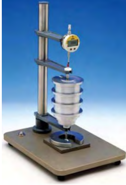
Şekil 5.2 WIRA Dijital kalınlık ölçer ( https://aygenteks.com )
