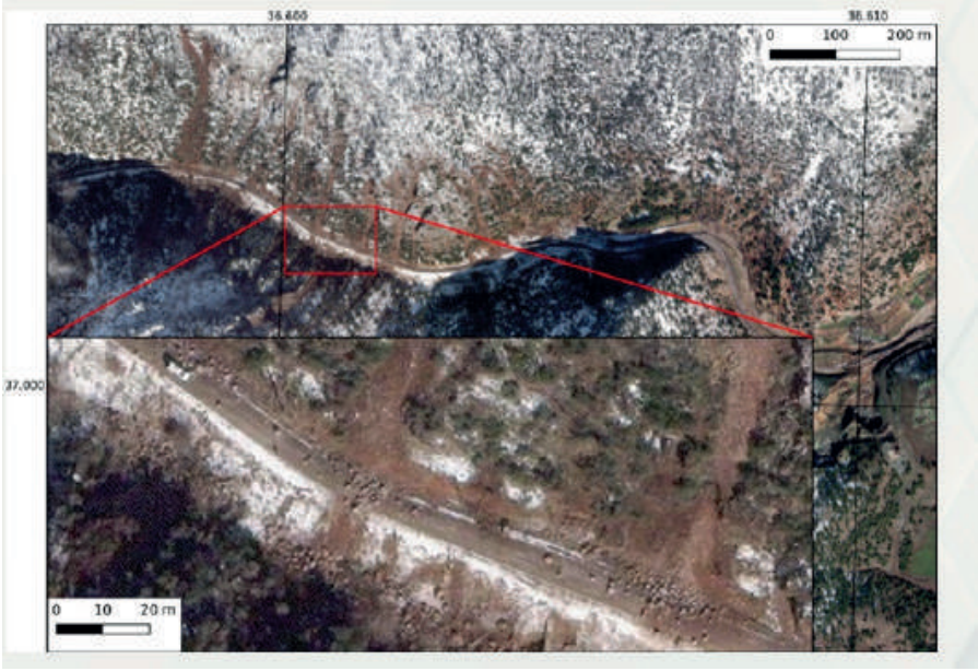
Şekil 3. İslahiye (Gaziantep) kuzeyindeki kaya düşmeleri (Kaynak görüntü: MAXAR - 2023).
