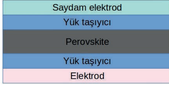
Şekil 2: Tabakalı yapıya sahip Perovskite tabanlı güneş hücresinin genel yapısı.
