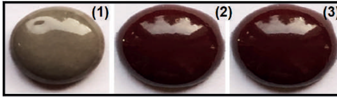
Şekil 13. “D7” kodlu örneğe, farklı sıcaklık ve sürelerde doplanan Demir Oksit sonucunda sinterlenmiş örnekler. (Tüm örneklerin çapları yaklaşık 15 mm’dir). (1) 650 °C’de 90 dk.’da katı hal sinterleme ile elde edilen 0,025 gr. \text{Fe}_2\text{O}_3 ile doplanmış D7.41 örneği. (2) 650 °C’de 60 dk.’da katı hal sinterleme ile elde edilen 1 gr. \text{Fe}_2\text{O}_3 ile doplanmış D7.42 örneği. (3) 650 °C’de 90 dk.’da katı hal sinterleme ile elde edilen 1 gr. \text{Fe}_2\text{O}_3 ile doplanmış D7.43 örneği.
