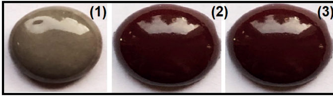
Şekil 13. “D7” kodlu örneğe, farklı sıcaklık ve sürelerde doplanan Demir Oksit sonucunda sinterlenmiş örnekler. (Tüm örneklerin çapları yaklaşık 15 mm’dir). (1) 650 °C’de 90 dk.’da katı hal sinterleme ile elde edilen 0,025 gr. Fe_2O_3 ile doplanmış D7.41 örneği. (2) 650 °C’de 60 dk.’da katı hal sinterleme ile elde edilen 1 gr. Fe_2O_3 ile doplanmış D7.42 örneği. (3) 650 °C’de 90 dk.’da katı hal sinterleme ile elde edilen 1 gr. Fe_2O_3 ile doplanmış D7.43 örneği.
