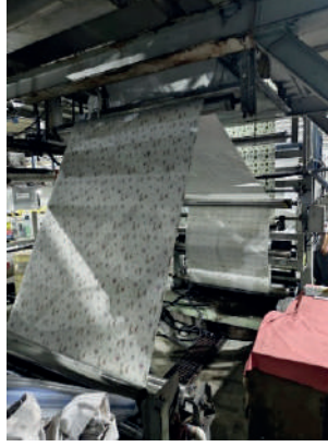
Şekil 49. Tasarlanmış kumaşların bitim (germe ve son işlem) işlemlerinin yapılması
