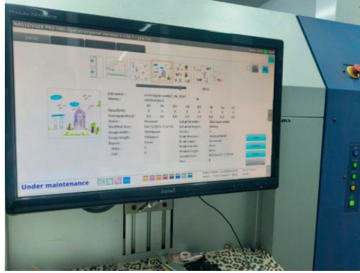
Şekil 46. Tasarlanmış kumaşın dijital baskı makinası kontrol ekranında baskı öncesi incelenmesi işlemi.
