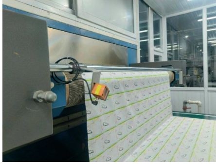
Şekil 47. Çocuklar için üretilmiş pamuklu kumaşın dijital baskı çıkış işlemi.
