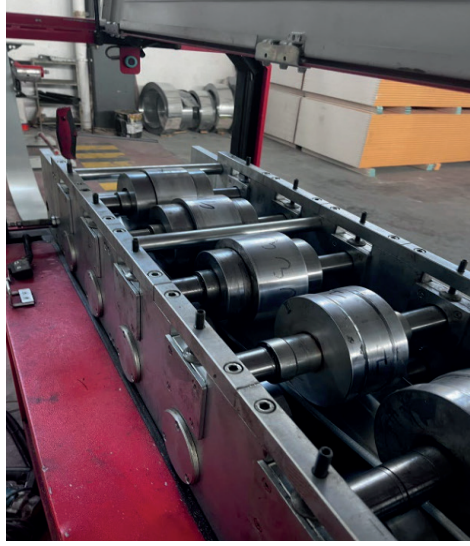
Şekil 2: Rulo form yöntemi ile soğuk şekil verme işlemi
