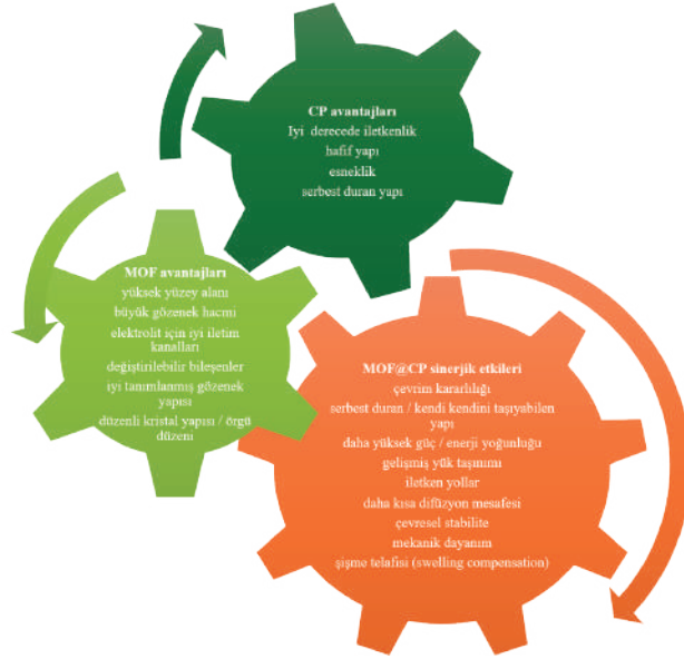
Şekil 1.3. CP, MOF ve MOF@CP Sinerjik Özelliklerinin Şematik Görünümü
